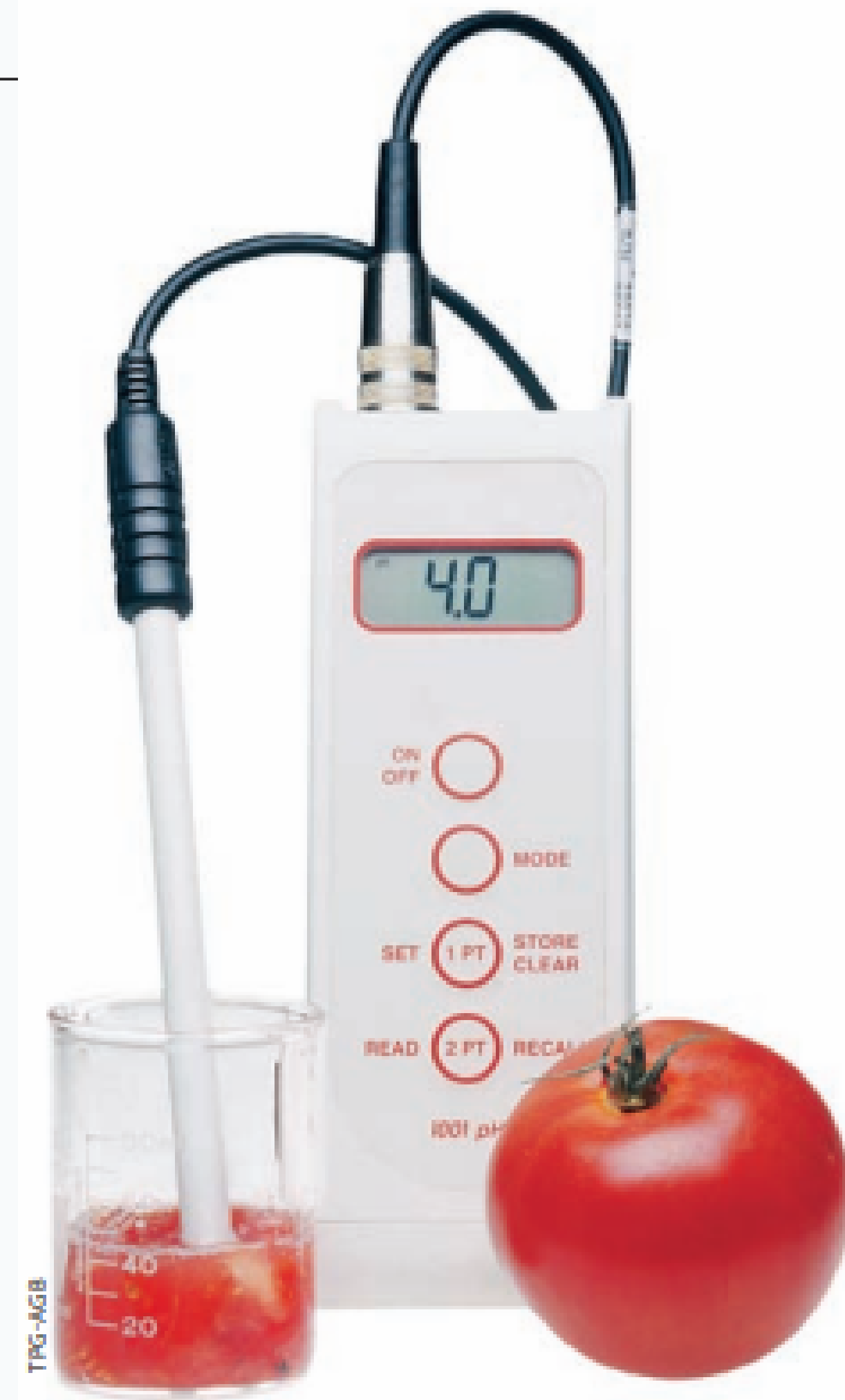
pHmetro (lê-se peagâmetro) digital indicando o pH de suco de tomate.
